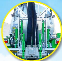
Antigoutte hydraulique (système TWIST)
